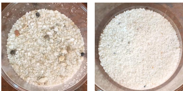
เปรียบเทียบหางแร่ก่อน (A) และหลัง (B) ผ่านการแต่งด้วยวิธีทางเคมี
