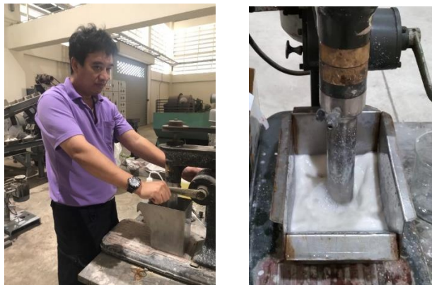
การกวนขัดผิวเม็ดแร่ ด้วยเครื่องลอยแร่
