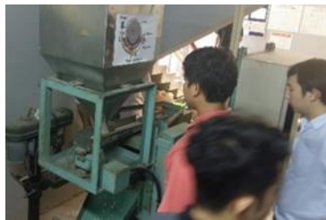
บริษัท พี. แอนด์ เอส. แบโรท์ ไมน์นิ่ง จำกัด การเพิ่มคุณภาพของแร่แบไรต์ ด้วยการประยุกต์ใช้ Magnetic Separator
