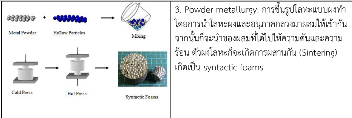
รูปที่ 6-27 แสดงขั้นตอนการผลิตโลหะโฟม
