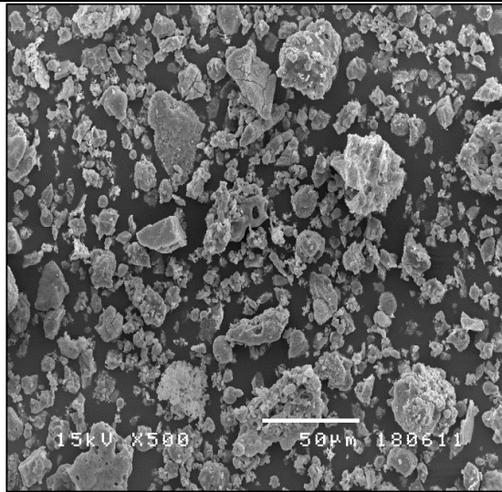
รูปที่ 6-5 ภาพถ่าย SEM ของเถ้าลอยที่ผสมปูนขาว (ต่อ)
