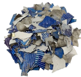
รูปที่ 8 แผ่นซิลิกอนที่ได้จากการตัดแยก
