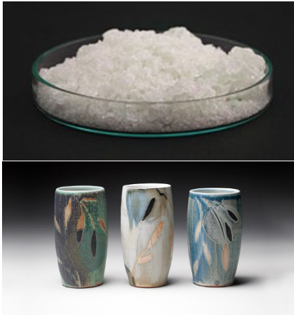
รูปที่ 2 ตัวอย่างฟริท (Frit) สำหรับสารเคลือบชนิด Engobe
