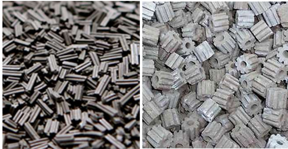
รูปที่ 1 ตัวอย่างลักษณะทางกายภาพของสารเร่งปฏิกิริยานิกเกิลใช้งานแล้ว
