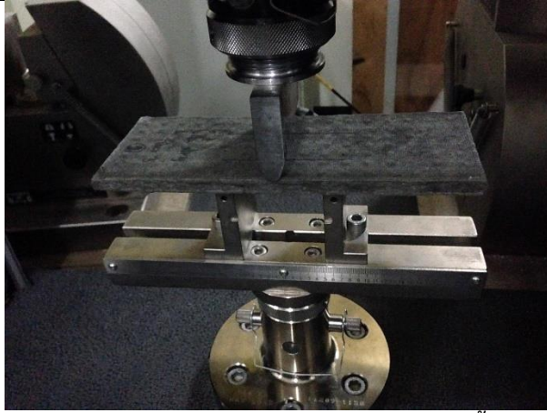
รูปแสดงการทดสอบความต้านทานแรงดัดกระเบื้อง
