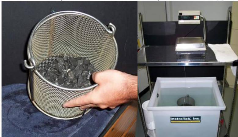
รูปการทดสอบความถ่วงจำเพาะของมวลรวมหยาบ (Pavement interactive, 2013)
