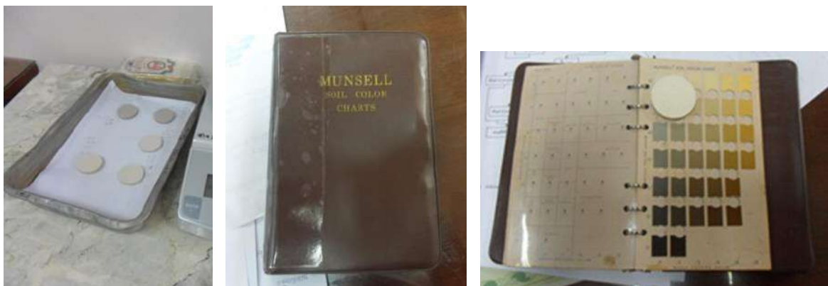
รูปที่ 9 การนำตัวอย่างแร่ปั้นชิ้นงานมาตรวจสอบสี โดยเปรียบเทียบกับ Munsell Soil Color Charts
