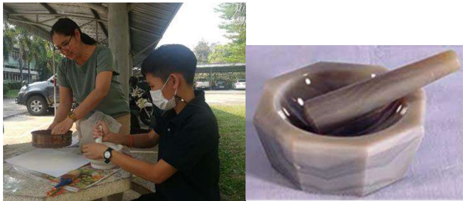
รูปที่ 4 การบดตัวอย่างด้วยโกร่ง แล้วร่อนด้วยตะแกรง
