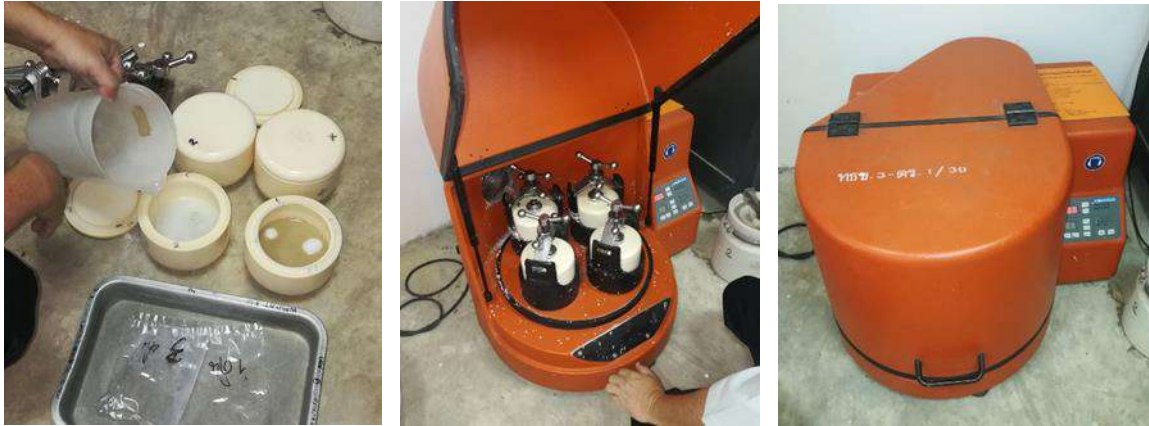
รูปที่ 7 ทำการบดแบบเปียกด้วยเครื่องบดละเอียด (ball mill)
