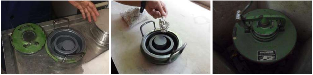
รูปที่ 6 การบดตัวอย่างด้วยเครื่องบดละเอียด (Disk Grinder)
