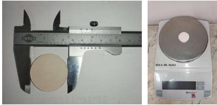
รูปที่ 10 การวัดเส้นผ่านศูนย์กลางและชั่งน้ำหนักของแป้นขึ้นงาน
