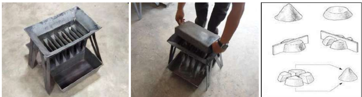
รูปที่ 2 แบ่งตัวอย่างด้วยเครื่องแบ่งตัวอย่าง (Jones Riffle Splitter) หรือด้วยวิธี Coning and quartering
