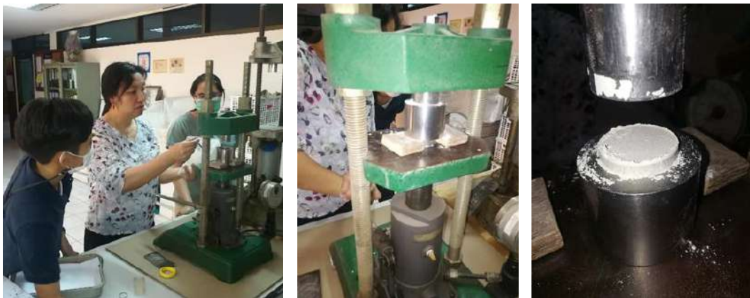
รูปที่ 8 การอัดขึ้นรูปแผ่นชิ้นงานให้เป็นแผ่นกลมแบนด้วยเครื่องอัดไฮดรอลิก
