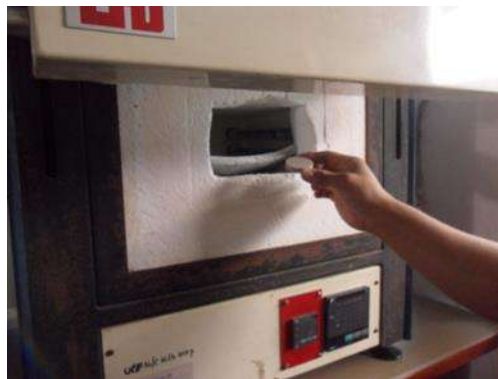
รูปที่ 11 นำตัวอย่างไปเผาที่อุณหภูมิ 1,200 องศาเซลเซียส โดยคงอุณหภูมิไว้ 30 นาที
