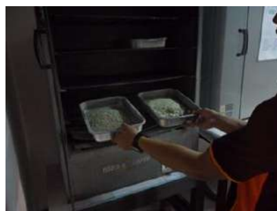
รูปที่ 3 นำตัวอย่างไปอบเพื่อไล่ความชื้นที่อุณหภูมิ 80 – 100 องศาเซลเซียส จนแห้ง
