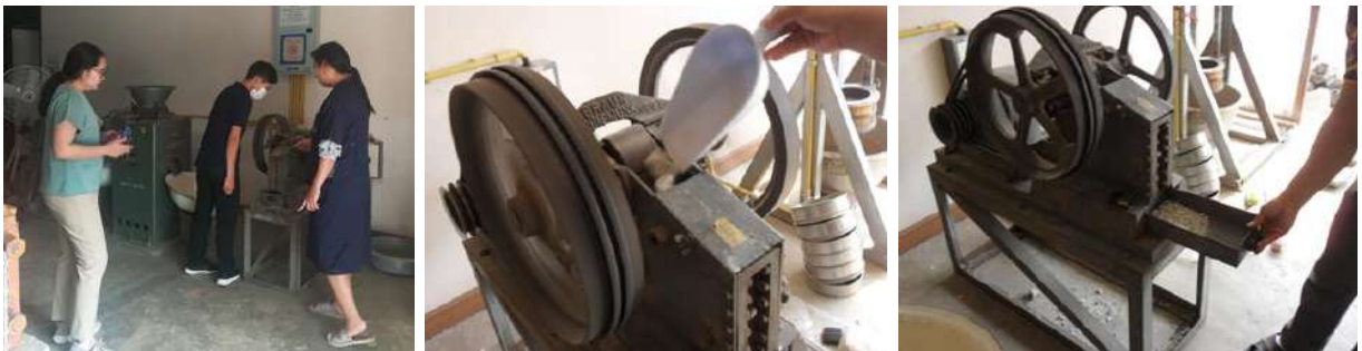
รูปที่ 1 กรณีตัวอย่างเป็นก้อนขนาดใหญ่ นำมาบดย่อยให้มีขนาดเล็กลง จนมีขนาด < 1 นิ้ว
