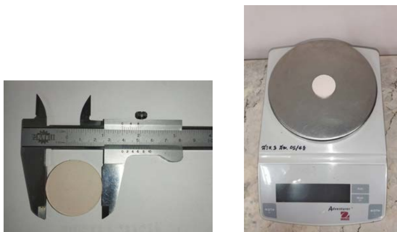
รูปที่ 10 การวัดเส้นผ่านศูนย์กลางและชั่งน้ำหนักของแป้นชิ้นงาน
