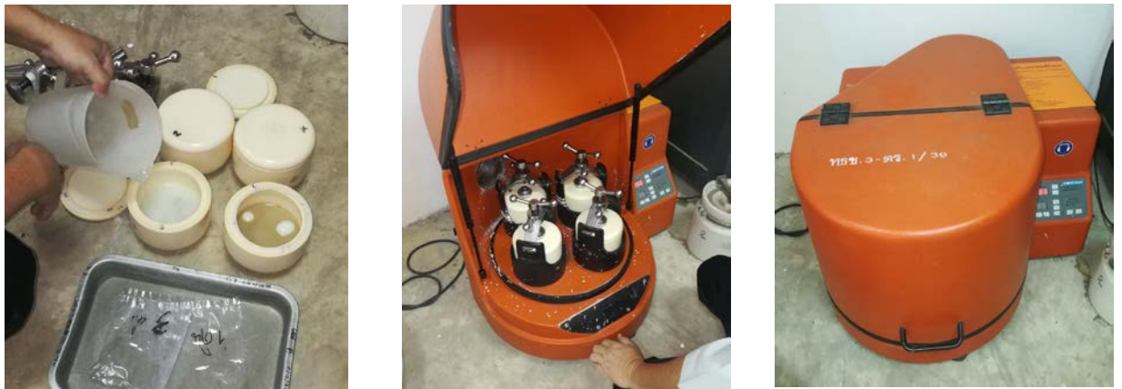
รูปที่ 7 ทำการบดแบบเปียกด้วยเครื่องบดละเอียด (ball mill)
