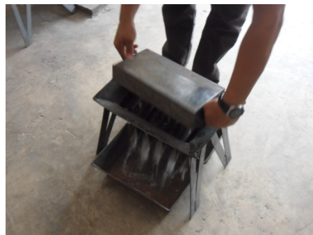
รูปที่ 2 แบ่งตัวอย่างด้วยเครื่องแบ่งตัวอย่าง (Jones Riffle Splitter) หรือด้วยวิธี Coning and quartering
