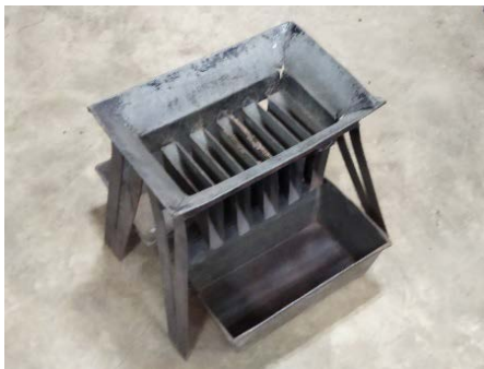
รูปที่ 2 แบ่งตัวอย่างด้วยเครื่องแบ่งตัวอย่าง (Jones Riffle Splitter) หรือด้วยวิธี Coning and quartering
