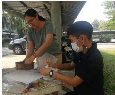
รูปที่ 4 การบดตัวอย่างด้วยโกร้ง แล้วรอนด้วยตะแกรง
