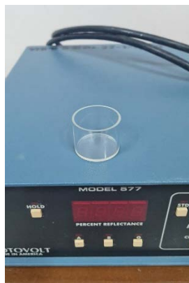
รูปที่ 5 เครื่องวัดค่าความขาวสว่าง Photovolt Reflectance Colorimeter 577-A
