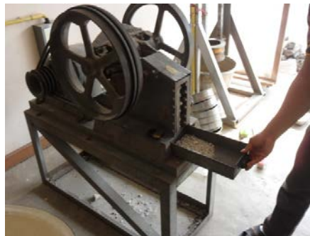
รูปที่ 1 กรณีตัวอย่างเป็นก้อนขนาดใหญ่ นำมาบดย่อยให้มีขนาดเล็กลง จนมีขนาด < 1 นิ้ว
