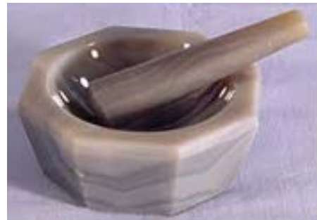
รูปที่ 4 การบดตัวอย่างด้วยโกร้ง แล้วรอนด้วยตะแกรง
