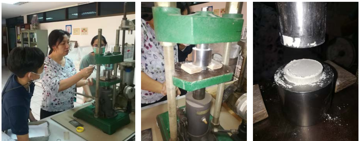
รูปที่ 8 การอัดขึ้นรูปแผ่นชิ้นงานให้เป็นแผ่นกลมแบนด้วยเครื่องอัดไฮดรอลิก
