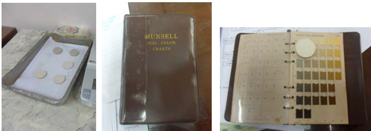
รูปที่ 9 การนำตัวอย่างแร่แป้นชิ้นงานมาตรวจสอบสี โดยเปรียบเทียบกับ Munsell Soil Color Charts
