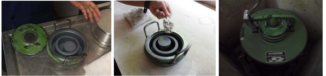
รูปที่ 6 การบดตัวอย่างด้วยเครื่องบดละเอียด (Disk Grinder)
